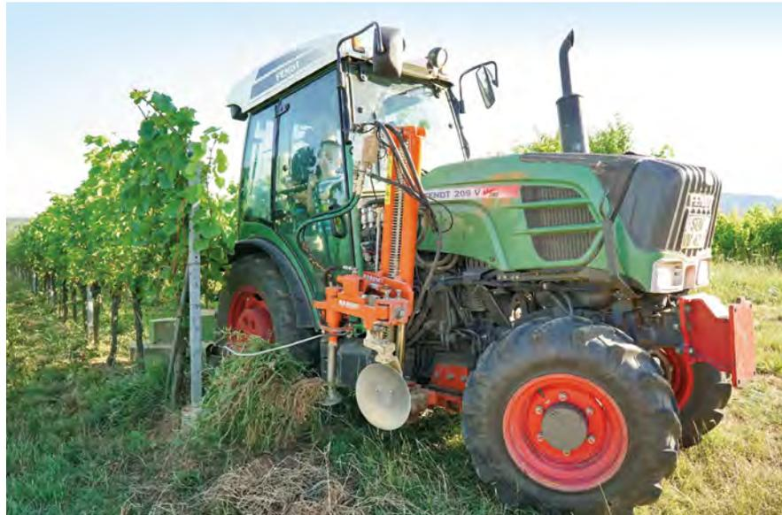
Angepasster Maschineneinsatz: Nutzung von Gerätekombinationen, wie hier z.B. mit beidseitigem Flachschaar im Zwischenachsenbau und Mulcher am Heck, um 40 % Zeit und 30 % Kraftstoff einzusparen sowie den Boden zu schonen.
